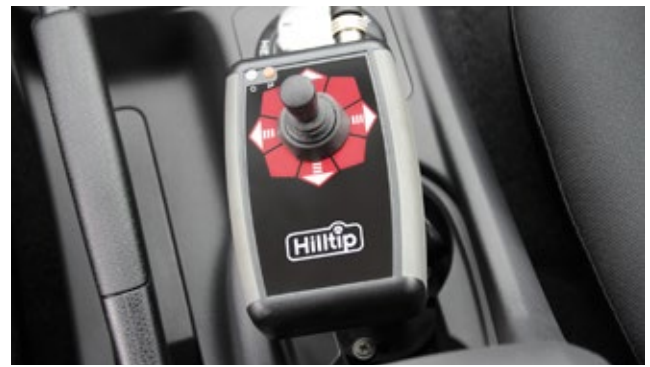
PFLUG-JOYSTICK - Leicht zu bedienender Innenraum-Joystick für eine einfache Steuerung des Schneepfluges (nur bei elektrohydraulischen Modellen)
