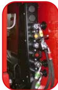
Der Unterbau, ebenso die Hydraulikanschlüsse, werden passend für jede Transportermarke ausgeführt.
