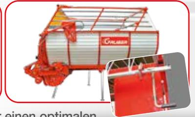
Die Gleitplane ist mit Federn für einen optimalen Futterfluss gespannt und die Dachbespannung mit extrem dehnbaren Spezialseilen zieht sich nach Entspannung wieder in die Ausgangslage zurück.
