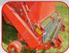
Die Pendel – Pickup mit 1,80 m Breite passt sich durch die 3-Punkt Lagerung ideal an das Gelände an und verliert auch in Extremsituationen nicht den Bodenkontakt.
