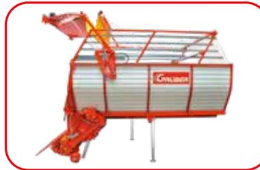
Serienmässig ist die hydraulische Rückwandöffnung. Beim Abladen schwenkt der obere Planenbügel mit der Rückwand ca. 33 cm nach oben und nimmt den Futterdruck weg, die Fuhre wird locker ausgestoßen.
