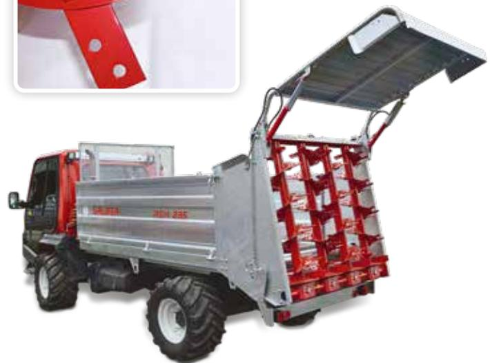
Das feinmaschige Spritzgitter schützt Fahrer und Transporterkabine vor Steinschlag und Verschmutzung. Die seitlichen Bordwände sind klappbar, so ist der Streuer gut zu reinigen. Das Streuwerk ist leicht aushängbar. Die vollverzinkte Brücke mit Siebdruckplatten-Boden (21 mm) bietet idealen Korrosionsschutz gegenüber dem aggressiven Ladegut.
